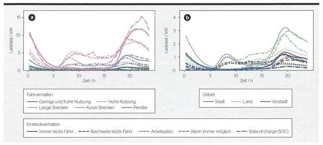
**Bild 2** Ladelast eines durchschnittlichen privaten EV **a)** mit verschiedenen Fahrverhalten und **b)** in verschiedenen Gebieten, unter der Annahme von 100 % Elektrifizierung der Autoflotte. Die Unterschiede zwischen den Linien gleicher Farbe zeigen jeweils die Flexibilität, die sich aus dem veränderten Einsteckverhalten ergeben kann. Basierend auf [1].
