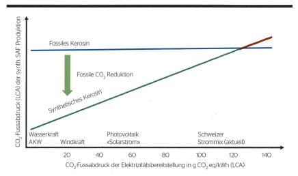
**Bild 1** Abhängigkeit der fossilen CO<sub>2</sub>-Reduktion von der Art der Elektrizitätsbereitstellung bei synthetischer Kerosinherstellung. Ganzheitliche Betrachtung (Life Cycle Analysis, Graue Emissionen).
