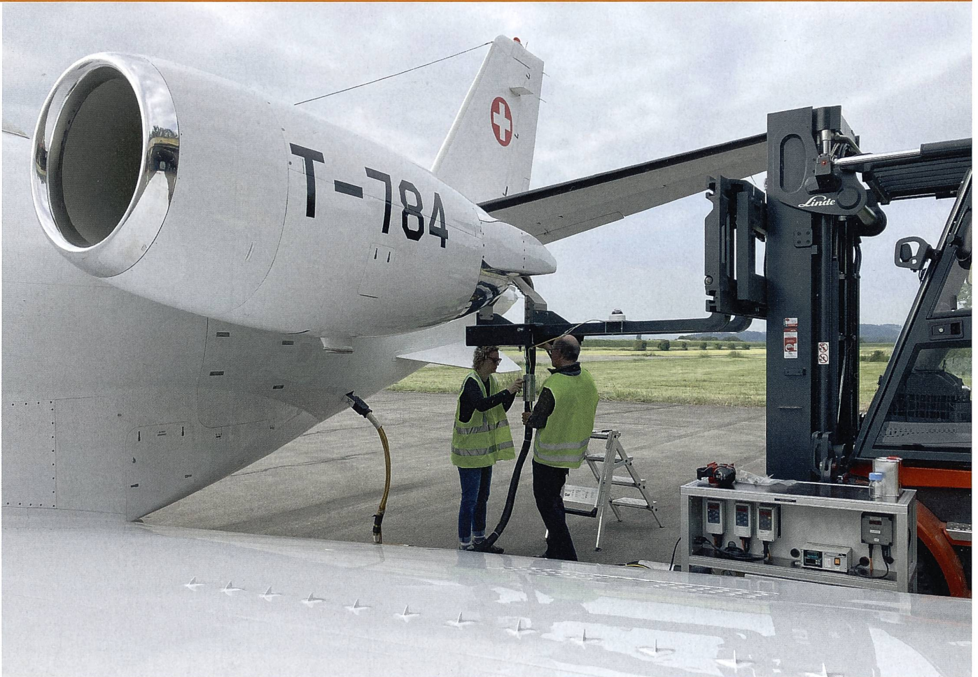
Abgasmessungen bei Verwendung eines nachhaltigen Flugtreibstoffs in Payerne, Mai 2023.
