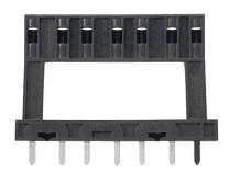
Beim Zählerwechsel fliesst der elektrische Strom über den Überbrückungsgriff, bis der neue Zähler wieder montiert ist. Bei der angebotenen ZSK von Hager ist der Überbrückungsgriff im montierten Zustand, ohne eingesetzten Zähler, verriegelt. So ist sichergestellt, dass kein Lichtbogen gezogen werden kann, da der Griff nur bei montiertem Zähler entfernt werden kann.
