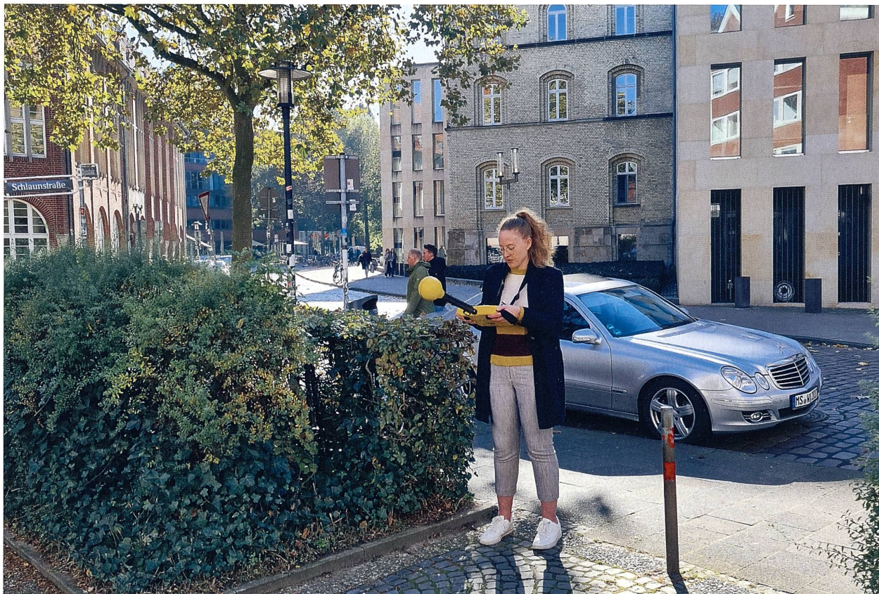
Messung mit portablem Spektrumanalysator und isotroper Messsonde.
