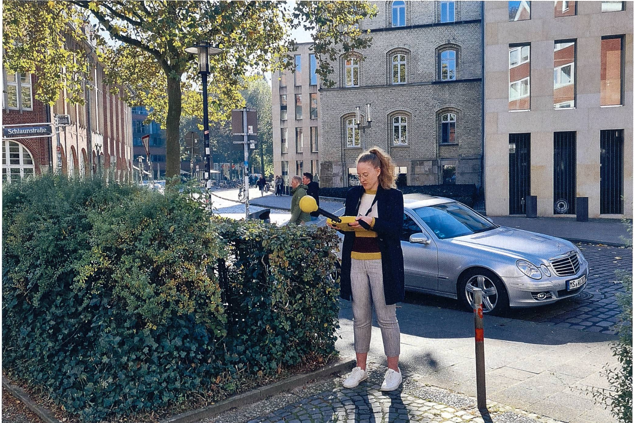
Messung mit portablem Spektrumanalysator und isotroper Messsonde.
