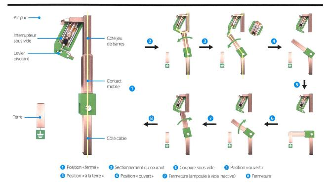
**Figure 1** Principe de fonctionnement (représenté pour une phase) d'un interrupteur-sectionneur à trois positions utilisant la technologie SVI (interruption par shunt sous vide).
