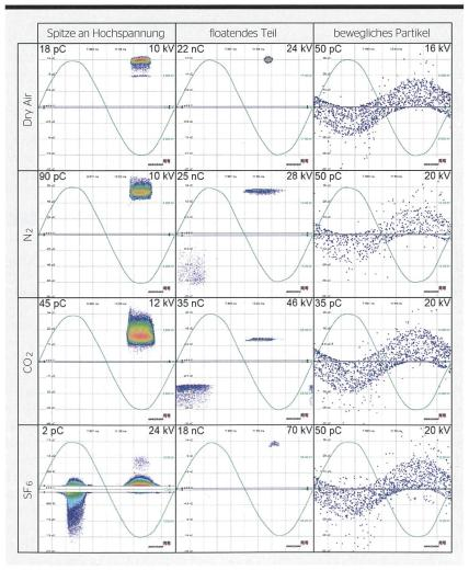
**Bild 3** Beispiel des Teilentladungsverhaltens von Partikeln von drei typischen Fehlern in  $N_2$ ,  $CO_2$  und Luft (Dry Air) im Vergleich zu SF<sub>6</sub>. bei O,5 MPa und 1,1-facher Teilentladungseinsatzspannung [3].
