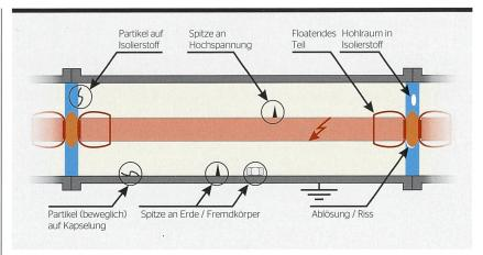
Bild 2 Übersicht üblicher Fehler in gasisolierten Betriebsmitteln [2].
