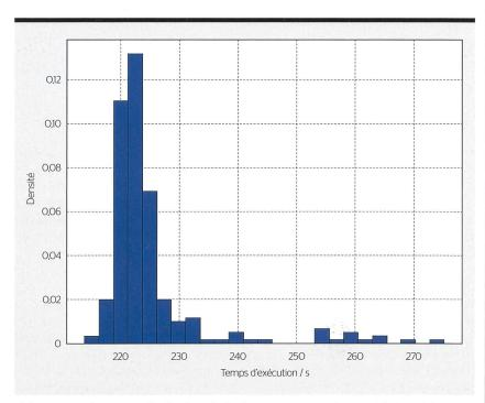
Histogramme des temps d'exécution: la durée moyenne pour le calcul de la prévision décentralisée de la charge et de l'analyse des flux de charge est d'environ 220 s dans le cas d'un réseau de distribution avec 30 clients finaux. Pour ce calcul, environ 20 000 points de données sont considérés.
