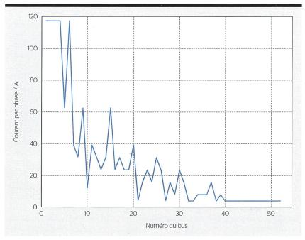
Le projet de recherche permet de déterminer la charge au niveau de chaque élément du réseau de distribution, et ce, aussi bien pour les transformateurs que pour les lignes de distribution. L'axe X représente les différents éléments du réseau de distribution selon leur numéro de nœud, et l'axe Y le courant circulant à travers chaque élément du réseau de distribution.
