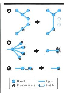
Figure 1 Exemples schématiques de certains des algorithmes d'agrégation implémentés: a) le regroupement des lignes en série, b) le regroupement des consommateurs connectés à un même point de réseau, et c) la suppression des fusibles connectés à un unique consommateur.
