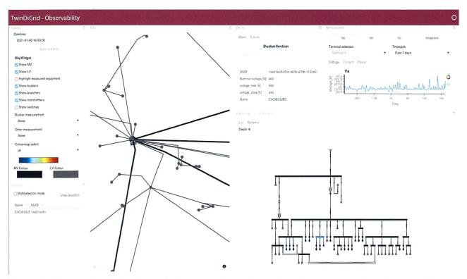
**Figure 3** Plateforme de visualisation illustrant la liaison automatique entre le schéma électrique et la représentation géographique du réseau, ainsi que l'historique de mesure de tension sur une phase d'un composant sélectionné (en bleu).
