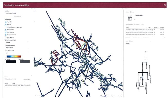
**Figure 2** Plateforme de visualisation illustrant l'état du réseau en termes de flux de puissance par ligne ainsi que les tensions par nœud aux niveaux moyenne et basse tension.
