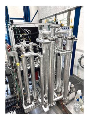
**Bild 3** Empa-Laboranlage mit sorptionsverstärkter Methanisierung.
