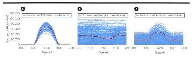
**Bild 1** 100 MW Nennleistungs-Stromerzeugungsprofil **a)** mittels PV, **b)** mittels Windkraft sowie **c)** mittels einer Kombination von Solarund Windkraft (je 50 MW Nennleistung). Blau: tägliche Werte; Rot: über das Jahr gemittelte Werte.
