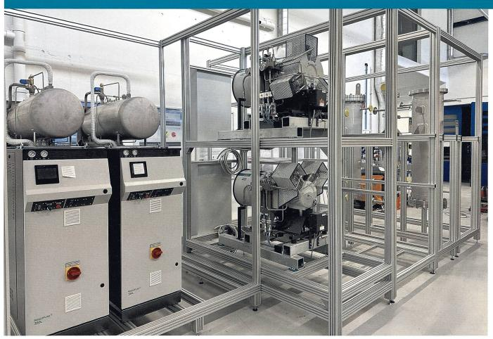
Methanisierungsdemonstrator an der Empa (im Aufbau).
