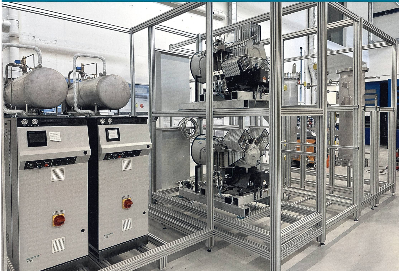
Methanisierungsdemonstrator an der Empa (im Aufbau).
