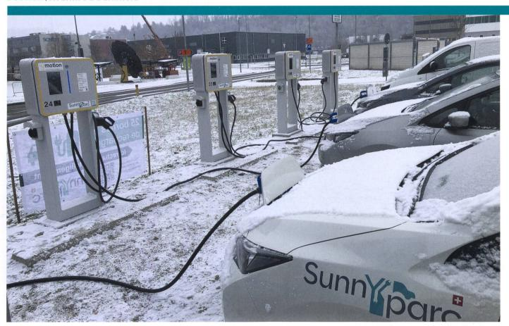
Décharge V2G simultanée de trois véhicules à 10 kW.
