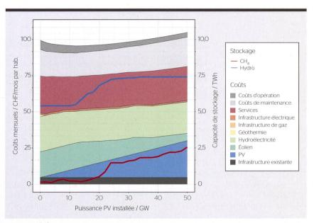
**Figure 2** Évolution de la composition des coûts du système économiquement optimal en fonction de la puissance photovoltaïque installée (cas d'étude: une Suisse indépendante et neutre en 2050 au coût minimal). L'axe secondaire représente la capacité requise de stockage saisonnier.
