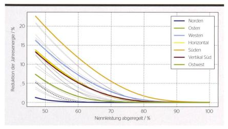
Bild 3 Abregelverluste.
