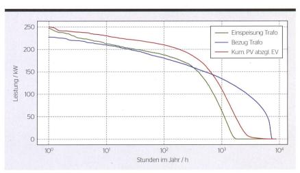
**Bild 1** Jahresdauerlinie am Transformator. Grün: Einspeiseleistung. Blau: Bezugsleistung. Rot: kumulierte Leistung der Zählpunkte mit PV-Anlagen abzüglich des Eigenverbrauchs.
