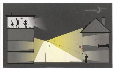
**Bild 1** Beispielhafte Darstellung einer Beleuchtungssituation und störender Lichtemissionen in der Nacht: Das Licht einer Aussenleuchte (1) erhellt Strasse und Trottoir (2: genutztes Licht). Ein Teil des Lichts ist unnötig (3). Lichtemissionen können auch von Reklamebeleuchtungen (4) und Innenräumen (5) ausgehen und wirken sich negativ auf Flora und Fauna aus – zudem können sie den Menschen durch Wohnraumaufhellungen (6) und Blendungen (7) stören.
