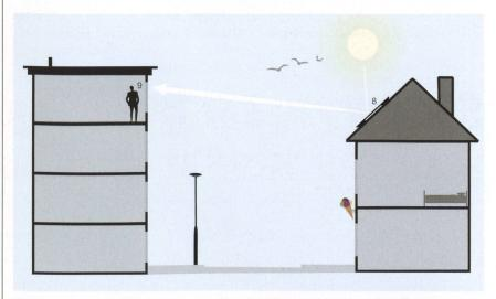
**Bild 2** Beispielhafte Darstellung von störenden Lichtemissionen am Tag: Sonnenlicht, dass an einer PV-Anlage (8) reflektiert wird, führt zu Blendungen (9).
