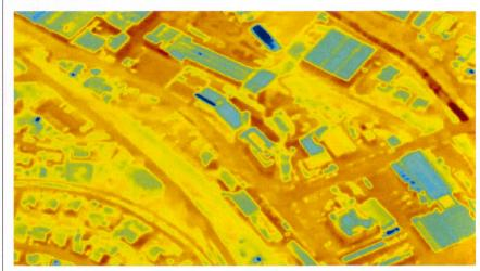
**Bild 2** Thermalaufnahmen von schräg montierten Infrarotkameras erlauben gleichzeitig Temperaturmessungen von Dächern und Fassaden.
