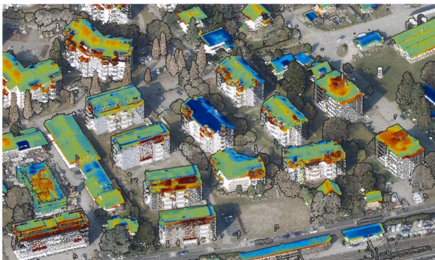
Bild 1 Hochaufgelöste Thermalaufnahmen der Dächer zeigen die Wärmeabstrahlung von blau (kälter) bis rot (wärmer) auf dem Hintergrund eines 3D-Oberflächenmodells (aus Lidar-Daten) eingefärbt mit Information aus RGB-Luftbildern.
