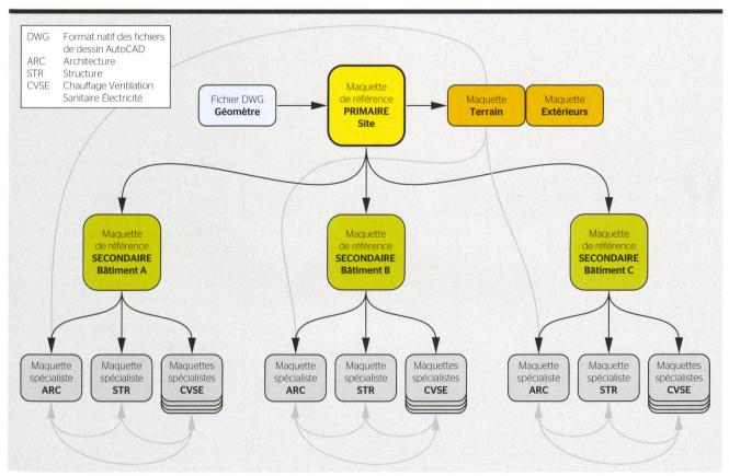
Figure 1 Principe général de mise en place des maquettes géoréférencées.
