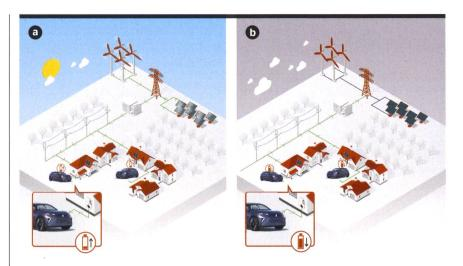
**Figure 1** Principe de la recharge bidirectionnelle: **a)** Les énergies renouvelables alimentent le réseau et l'offre d'énergie est supérieure à la demande: les véhicules électriques se rechargent. **b)** Lorsque l'offre d'énergie est inférieure à la demande, la recharge des véhicules s'arrête. Les véhicules branchés peuvent alors alimenter le réseau en électricité.
