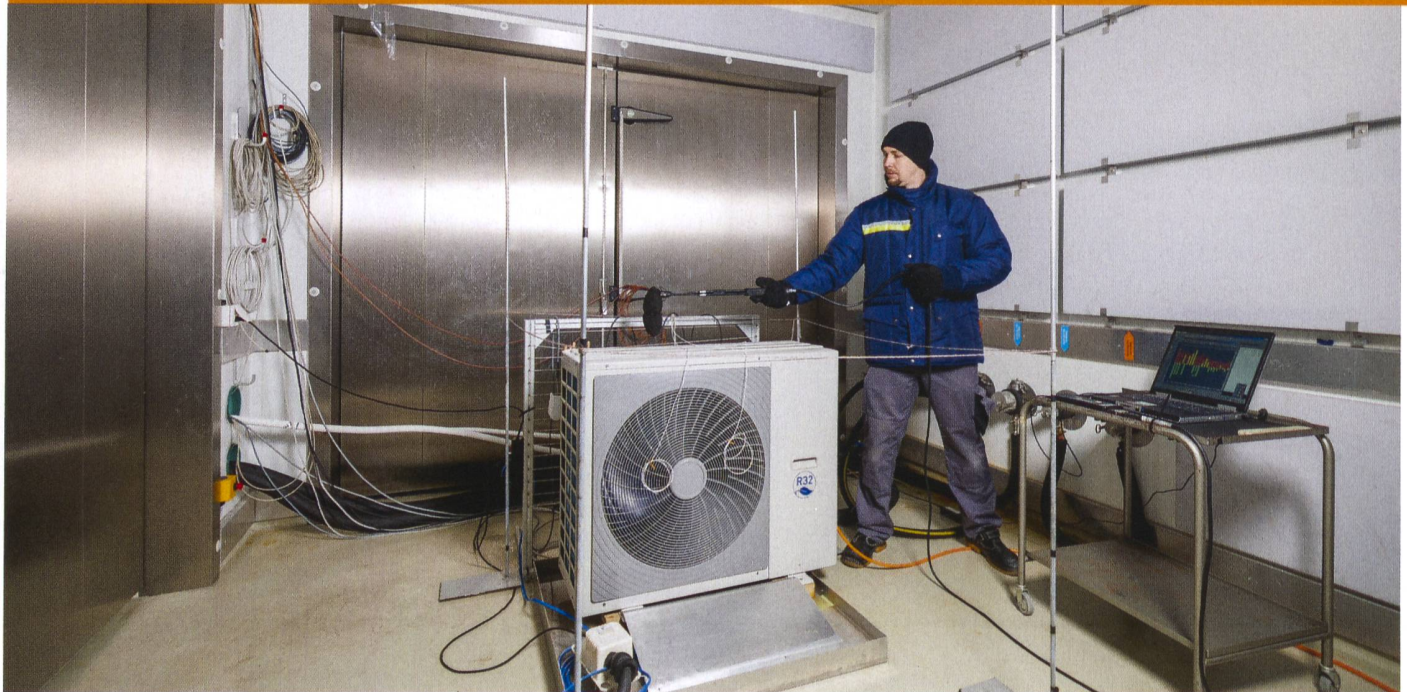
Luft-Wasser-Wärmepumpen-Test und Schallmessung am Wärmepumpen-Testzentrum (WPZ).
