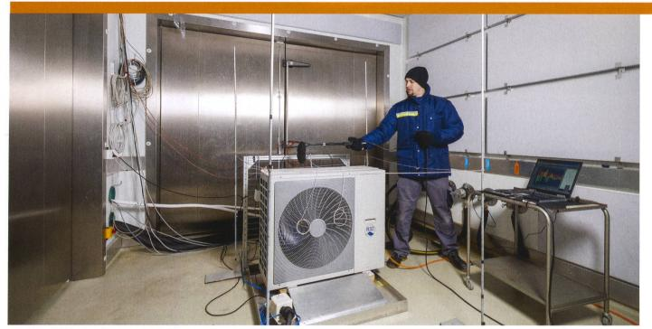
Luft-Wasser-Wärmepumpen-Test und Schallmessung am Wärmepumpen-Testzentrum (WPZ).
