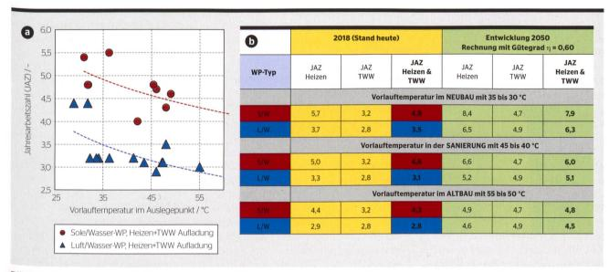
**Bild 2 a)** Jahresarbeitszahl (JAZ) von gemessenen WP in Abhängigkeit der Vorlauftemperatur im Auslegepunkt (eingestellte Heizkurve), **b)** Übersicht aktueller JAZ im Heizbetrieb (Heizen), für die Trinkwarmwassererwärmung (TWW) und in Kombination (Heizen & TWW), sowie die Effizienzentwicklung bis 2050 mit 60 % Gütegrad (Daten aus [5]).
