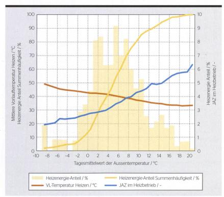
**Bild 4** Verteilung und Summenkurve des Heizenergieanteils einer L/W-WP mit Radiatoren im Mittelland nach Aussentemperatur (fürs Jahr 2018). Die Vorlauftemperatur (rot) und die JAZ im Heizbetrieb (blau) sind auch dargestellt.
