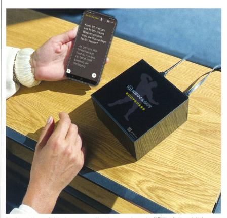
Die Smart-Home-Gebäudesteuerung Knockaut wurde an der HSLU mit einer lokalen Offline-Sprachsteuerung ausgerüstet und bietet dadurch höchste Privatsphäre.
