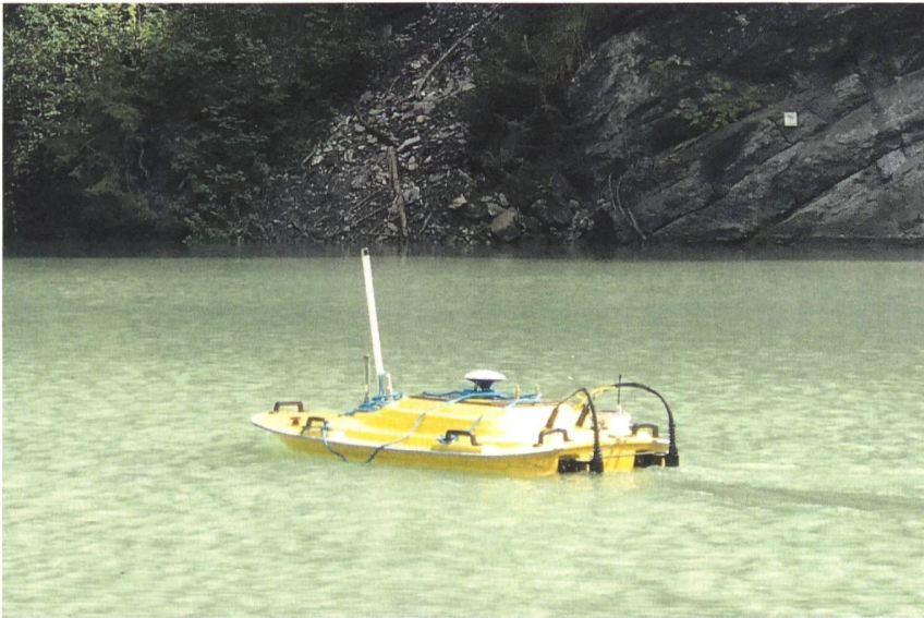
Bateau télécommandé équipé d'appareils de mesure, notamment pour la saisie de la hauteur du fond du lac de barrage et de la vitesse d'écoulement, utilisé par les chercheurs du VAW sur le lac de Solis.
