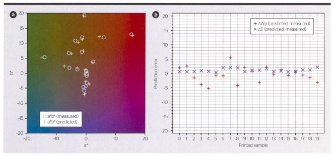
**Bild 5** Abweichungen bei der RE und bei den Farben für eine Serie von 19 PV-Modulen (Printed Sample). **a)** Ausschnitt aus dem Lab-Farbraum (Horizontalschnitt auf Höhe eines L von ca. 50). Die Abweichungen sind kaum sichtbar. **b)** Die Leistungsabweichungen liegen bei 5 W, was bezogen auf die Ausgangsleistung von 195 W einen Fehlerkorridor von ± 2,5 % ergibt. Die Farbabweichungen (E) sind auch unkritisch.
