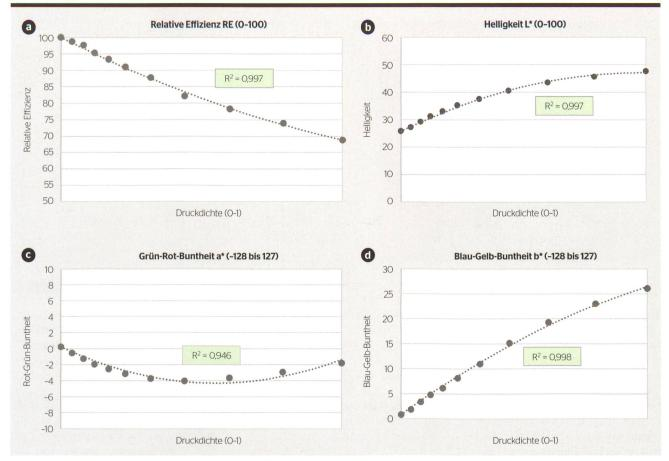
**Bild 4** Analyse für die Grundfarbe Orange. **a)** RE nimmt mit zunehmender Druckdichte ab (quadratische Funktion). **b)** Die Helligkeit steigt von 25,77 (unbedrucktes PV-Modul) bis knapp 50 an. **c)** Die Veränderung entlang der Grün-Rot-Achse ist minimal, weil diese Farben nicht in Orange enthalten sind. **d)** Der Gelb-Wert steigt um 26 Punkte. Bei allen Funktionen streuen die berechneten Werte nur sehr wenig um die Messwerte herum.
