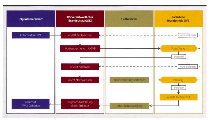
Bild 2 Klare Abläufe bei der GVB zur Projektbeurteilung von PV-Fassaden an Hochhäusern.
