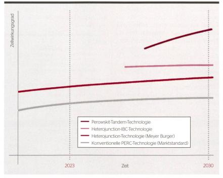
Bild 2 Zellwirkungsgradentwicklung der PV-Technologien über die Jahre.
