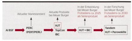
Bild 3 Die Entwicklungskette der PV-Technologien.
