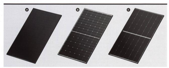
**Bild 1** Solarmodule in der Übersicht: **a)** Meyer Burger Black: Nennleistung 375-395 W, Effizienz 20,4-21,5 %; **b)** Meyer Burger White, mit weisser Backsheet-Folie: Nennleistung 380-400 W, Effizienz 20,7-21,7 %; **c)** Meyer Burger Glass, mit transparentem Rückseitenglas: Nennleistung 370-390 W, Effizienz 20,6-21,8 %.
