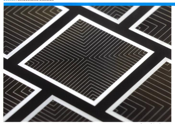
Topcore-Solarzelle aus dem Fraunhofer ISE.
