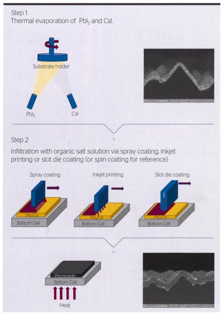
Beschichtung einer texturierten Siliciumunterzelle mit Perowskitschichten. Schritt 1: Abscheidung eines dünnen Films der anorganischen Komponenten (z. B. Csl, Pbl2, CsBr oder PbBr2). Schritt 2: Benetzung des anorganischen Dünnfilms mit der organischen Komponente aus der Lösung.
