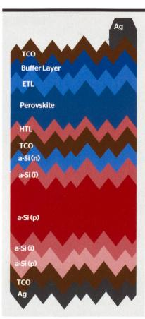
Skizze einer texturierten Perowskit-Silicium-Tandemsolarzelle mit einer p-Typ HJT-Unterzelle, wie sie für die Entwicklung am Fraunhofer ISE verwendet wurde.
