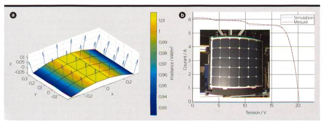
**Figure 4 a)** Irradiance en fonction de la position sur le module courbé ( $R_c = 0.9 \text{ m}$ ). **b)** Mesure courant-tension sous illumination standard et simulation d'un module courbé ( $R_c = 0.9 \text{ m}$ , avec diodes bypass).
