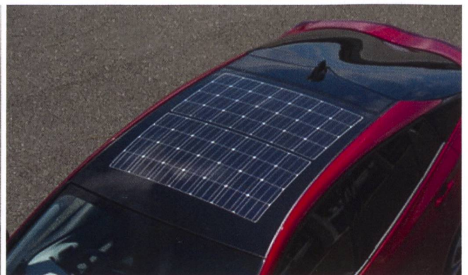
Figure 1 Le toit solaire est aujourd'hui disponible et peut être trouvé en option sur les véhicules hybrides produits en série tels que la Hyundai Sonata (à gauche) ou la Toyota Prius (à droite).
