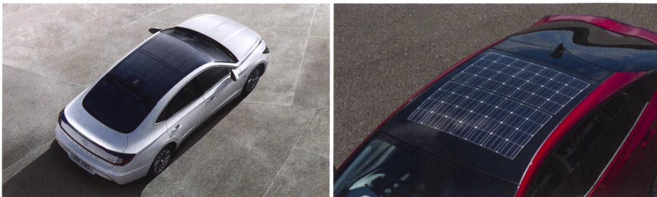
Figure 1 Le toit solaire est aujourd'hui disponible et peut être trouvé en option sur les véhicules hybrides produits en série tels que la Hyundai Sonata (à gauche) ou la Toyota Prius (à droite).
