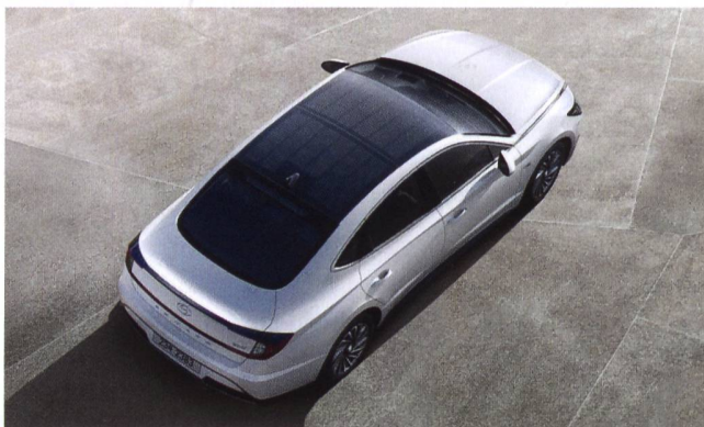
Figure 1 Le toit solaire est aujourd'hui disponible et peut être trouvé en option sur les véhicules hybrides produits en série tels que la Hyundai Sonata (à gauche) ou la Toyota Prius (à droite).
