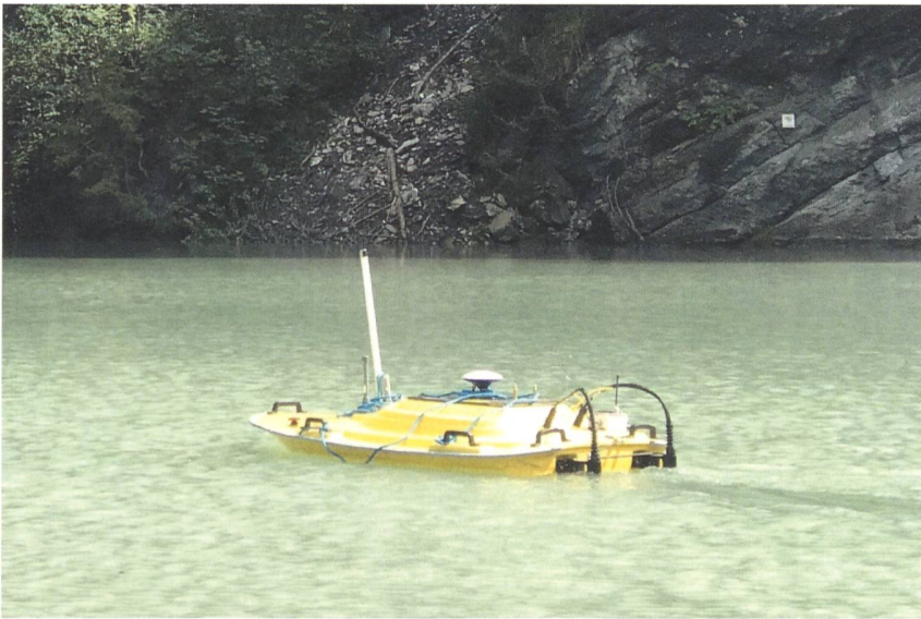
Ein ferngesteuertes Boot mit Messgeräten u.a. für die Erfassung der Höhe des Stauseebodens und der Strömungsgeschwindigkeiten, das vom VAW-Forschungsteam auf dem Solis-Stausee eingesetzt wurde.
