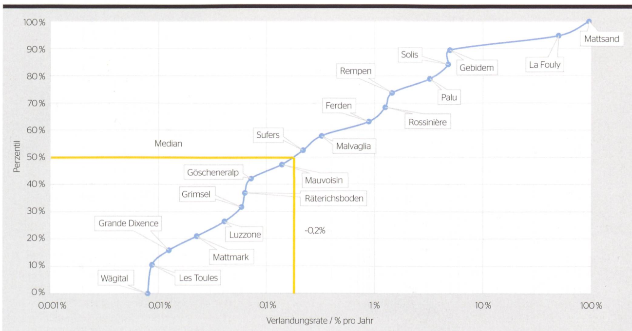
Die Grafik zeigt die Verlandungsrate (abgesetztes Sediment pro Jahr im Vergleich zum Stauvolumen) für ausgewählte Schweizer Stauanlagen unter Berücksichtigung allfälliger Sedimentmanagement-Massnahmen.
