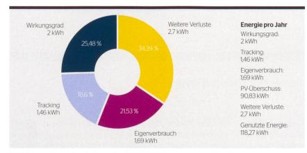
Bild 4 Verteilung der Verluste der Off-Grid-Webcam gemäss Tool-Berechnungen.
