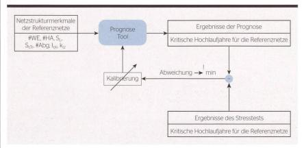
Bild 2 Schematische Darstellung zur Kalibrierung des Prognose-Tools.
