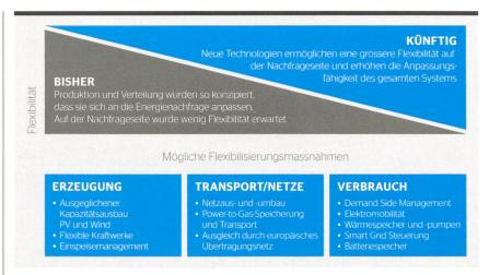
**Bild 1** Flexibilisierungsmassnahmen für den Ausgleich zwischen Stromproduktion und -verbrauch.
