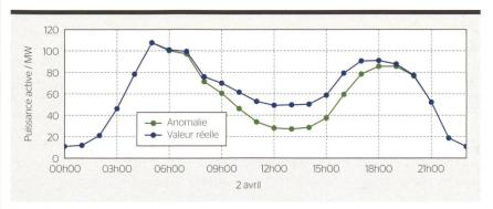
Figure 2 Anomalie de distorsion, générée pour une centrale hydroélectrique de retenue.
