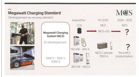
Un nouveau standard est en cours de définition afin de permettre la recharge des camions électriques avec une puissance de plusieurs MW.
