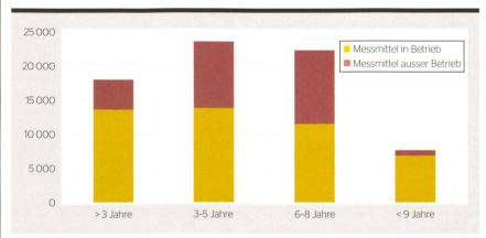
Die Lebensdauer von Messmitteln mit dem Messmittelmanagement-System Aptobase analysiert.
