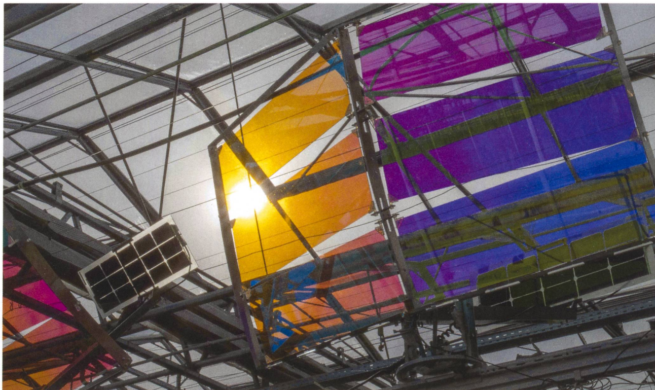
Système composé de six filtres réfléchissant la composante verte du spectre solaire ainsi que les infrarouges vers le panneau photovoltaïque.
