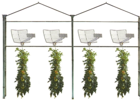
Figure 1 Schéma d'installation d'un système Voltiris X6 à six filtres par panneau solaire. Les réflecteurs se montent à l'intérieur de la serre, au-dessus des cultures.
