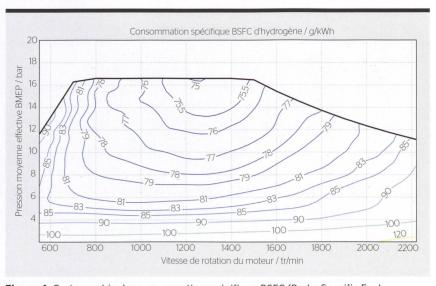
**Figure 4** Cartographie de consommation spécifique BSFC (Brake Specific Fuel Consumption) prévisionnelle d'hydrogène pour le FPT C13 H2 en fonction de la pression moyenne effective (BMEP, Brake Mean Effective Pressure), cette dernière correspondant au couple du moteur.
