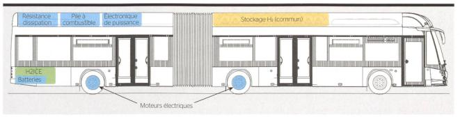
**Figure 1** Comparaison d'intégration des solutions hydrogène par rapport à une configuration diesel: ajout des composants nécessaires pour la solution avec pile à combustible (en bleu), remplacement ou modification du moteur à combustion dans la variante moteur à combustion à hydrogène (en vert), et ajout d'un stockage d'hydrogène (nécessaire pour les deux solutions, en jaune).
