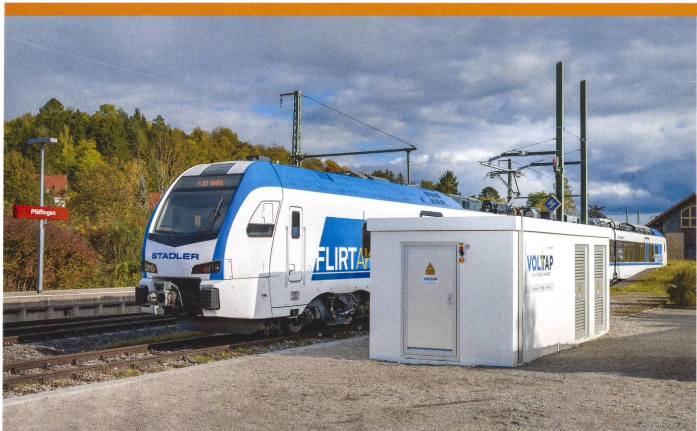
Prototyp der Voltap-Schnellladestation für Batteriezüge.
