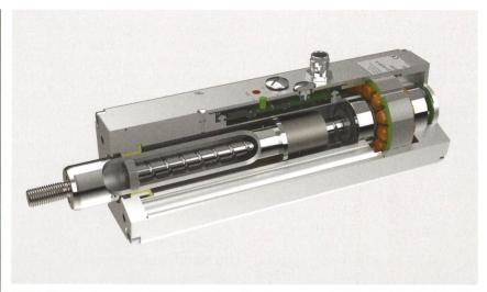
**Bild 1** Blick ins Innere des Elektrozylinders: Der Servomotor (rechts) treibt eine Spindel (links) an, welche die lineare Hin-und-her-Bewegung hervorruft. Mittig über der Spindel ist die Bedienkonsole mit dem Potentiometer angebracht, direkt darunter die Servoregler-Elektronik.
