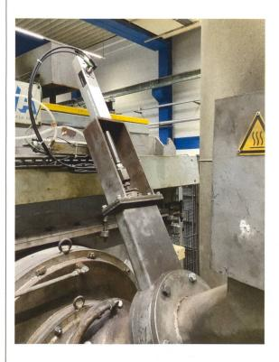
**Bild 2** Die Firma Stihl Kettenwerk war eines der Unternehmen, bei denen Druckluftzylinder durch Elektrozylinder ersetzt wurden.
