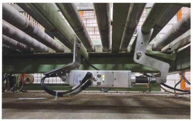
Einsatz von Elektrozylindern bei Micarna.
