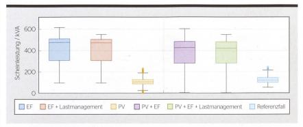
**Bild 3** Scheinleistung des zu bewertenden Transformators für Szenarien mit 9 neuen Ladestationen für Elektrofahrzeuge (EF) und 27 neuen PV-Anlagen.
