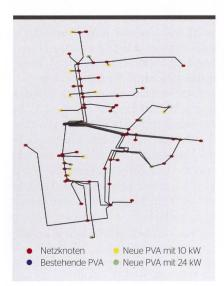
**Bild 2** Topologie eines analysierten Teilnetzes mit PV-Anlagen.
