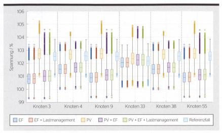
**Bild 4** Die am höchsten belasteten Knoten des untersuchten Netzes für Szenarien mit 9 neuen Ladestationen und 27 neuen PVs.
