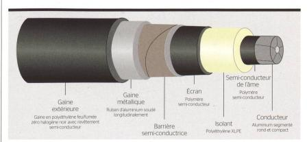
Figure 4 Schéma du câble unipolaire avec gaine en aluminium.
