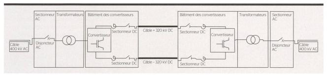
Figure 3 Le système HVDC.
