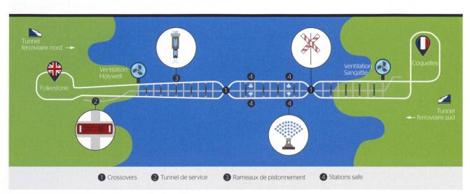
Figure 2 Configuration générale du tunnel sous la Manche.
