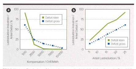
**Bild 4** Nexus-e-Ergebnisse: **a)** Lastreduzierung der Industrie bei variierender Entschädigung. **b)** Bei fester Vergütung von 500 CHF/MWh wird der Anteil der Last variiert, den die Firmen tatsächlich reduzieren können.
