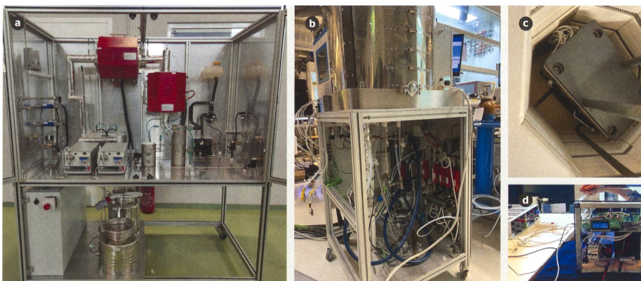
Figure 2 Preuve de concept réalisée dans le laboratoire GEM de l'EPFL : a) banc de test du reformeur, b) banc de test de la pile à combustible SOFC, c) pile à combustible SOFC et d) électronique de puissance.
