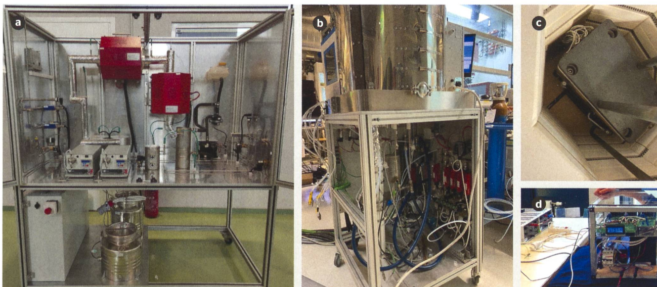
Figure 2 Preuve de concept réalisée dans le laboratoire GEM de l'EPFL : a) banc de test du reformeur, b) banc de test de la pile à combustible SOFC, c) pile à combustible SOFC et d) électronique de puissance.
