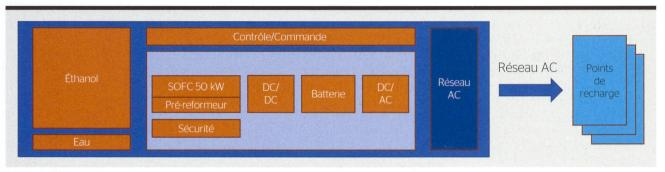
Figure 1 Schéma de principe du générateur.
