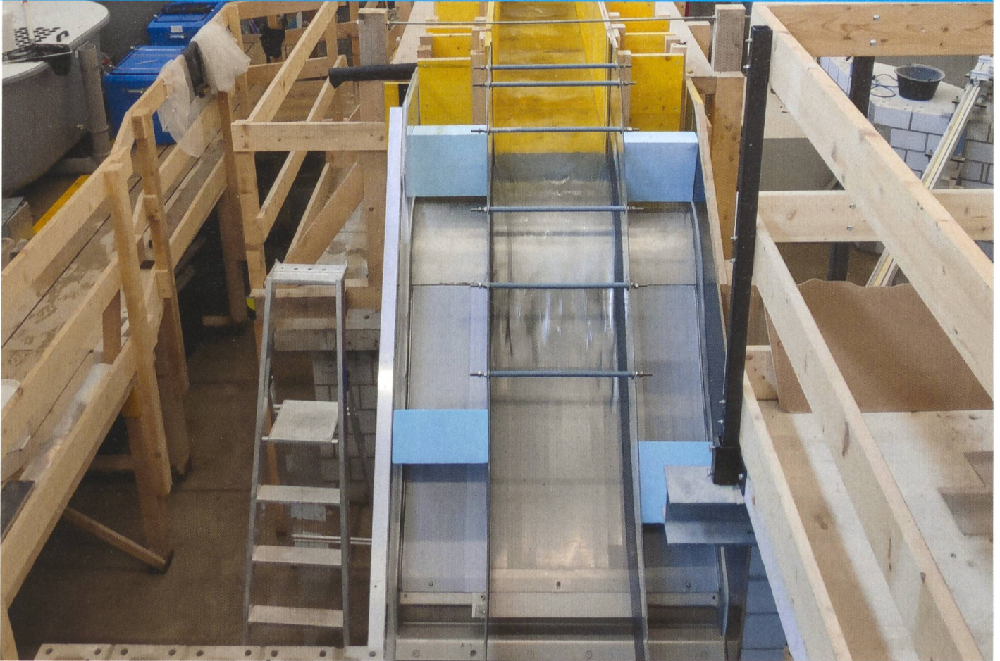
Versuchsstand, Rechenbreite auf 0,5 m verschmälert (Anblick von Unterstrom).
