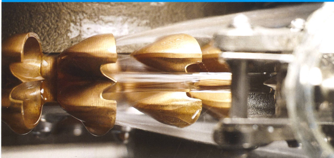
Jet impactant la roue d'une turbine Pelton à l'arrêt.
