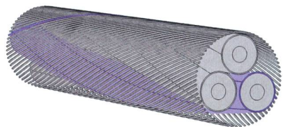
Bild 3 Modell mit den grundlegenden Merkmalen eines armierten Unterseekabels: Hauptleiter, Abschirmungen und Armierung.
