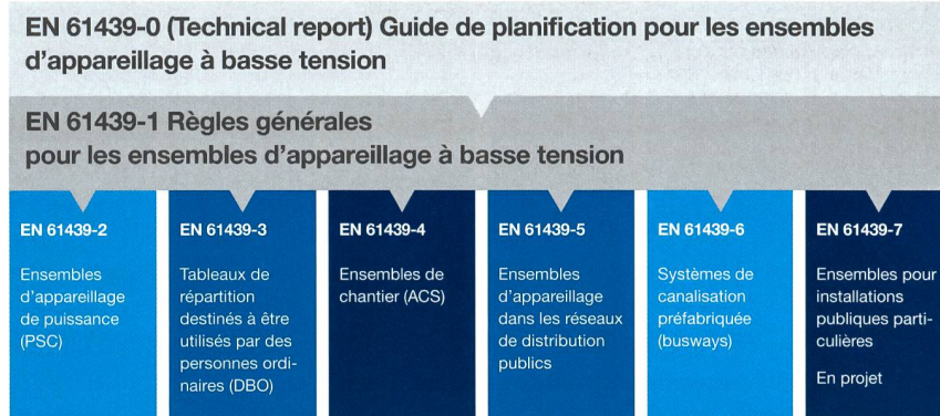
Structure de la norme EN 61439.
