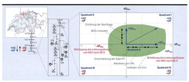
Bild 1 Konzept zur Aggregation von Flexibilitäten.
