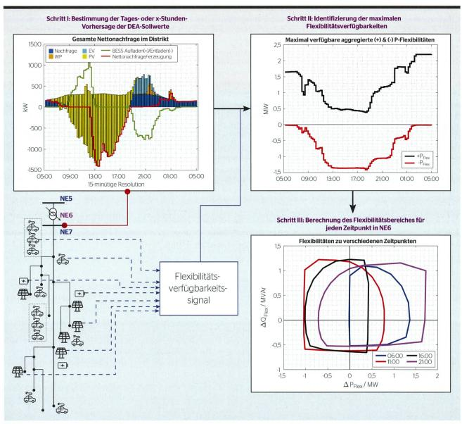
Bild 2 Beispiel zur Flexibilitätsaggregation in einem städtischen Verteilnetz.
