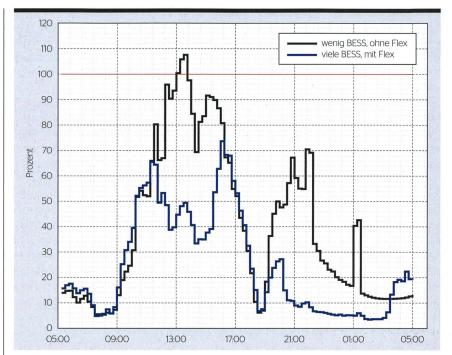
**Bild 3** Belastung des Transformators an einem Sommertag im Jahr 2050 mit hoher Sonneneinstrahlung. Schwarz: Wenig Batterien, keine Flexibilität, Blau: Viele Batterien mit netzdienlichem intelligentem Laden/Entladen und einfacher, regelbasierter Umsetzung, sowie leichter Verschiebung der Fahrpläne für Wärmepumpen und Ladestationen.
