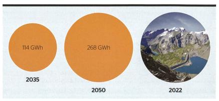
Die aggregierte Speicherkapazität von Elektrofahrzeugen in der Schweiz im Vergleich mit jener der Pumpspeicherkraftwerke.
