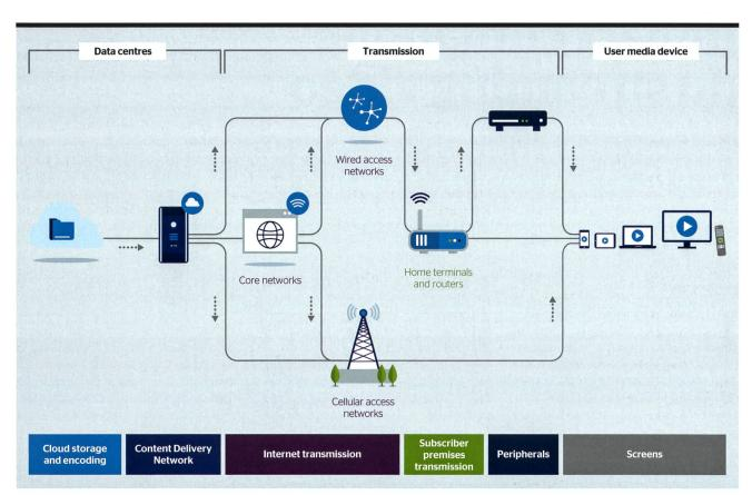
Limites du système: composants nécessaires au streaming de vidéos.
