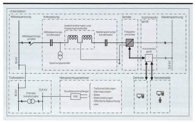
Bild 1 Prinzipschema einer Rundsteueranlage.
