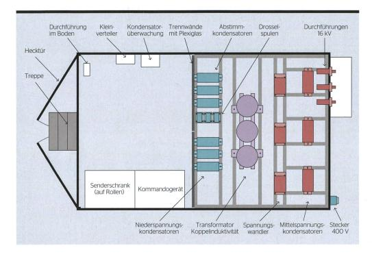
**Bild 2** Aufbau (Grundriss) der mobilen Rundsteueranlage.
