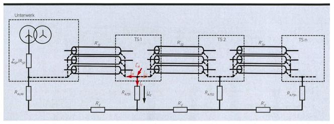
Bild 1 Erdverbindungen zwischen Unterwerk und Transformatorenstationen.
