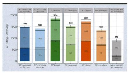
Bild 1 Durchschnittliche AC-Jahreserträge der Versuchsanlage Davos-Totalp (2500 m. ü. M, Südausrichtung) im Vergleich mit einer Anlage im Mittelland für die Jahre 2018 bis 2021. Die Doppel-T-Balken zeigen die Minimal- und Maximalwerte in den vier Jahren.
