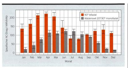
**Bild 2** Gemessene durchschnittliche spezifische Monatserträge der Versuchsanlage Totalp (bifazial, 90 Grad, Südausrichtung) im Vergleich mit einer Anlage im Mittelland für die Jahre 2018 bis 2021. Die Doppel-T-Balken zeigen die Minimal- und Maximalwerte in den vier Jahren.
