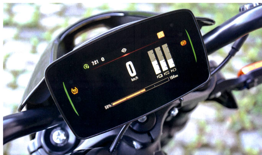
Clair et ordonné: l'écran indique les informations essentielles et peut afficher des données supplémentaires comme les températures de la batterie, de l'électronique de puissance et du moteur.
