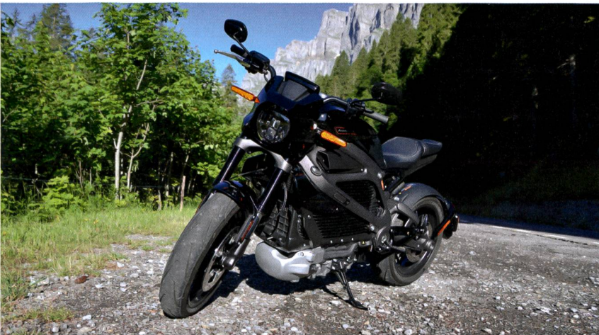
Au col du Klausen. Le moteur à refroidissement liquide est situé tout en bas et permet ainsi d'abaisser le centre de gravité, ce qui exerce un effet positif sur le comportement dans les virages.
